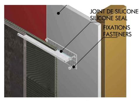
support, serré les quatre boulons de positionnement a la profondeur d'installation désirée et appliquer un cordon de silicone de façon a étanchéiser et fixer la profondeur de la cascade. (se référer au dessin d'installation) Il est aussi suggéré d'appliquer du silicone à l'arrière entre le support et la cascade afin d'offrir une résistance supérieur.
